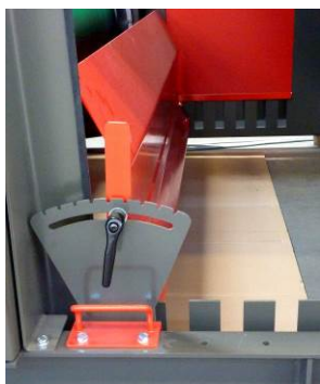
Foto: Separationsplåtar på uppsamlaren
