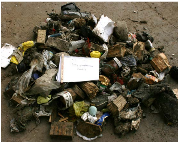
Figur 25. Tung grovfraktion från avfall som primärkrossats.
