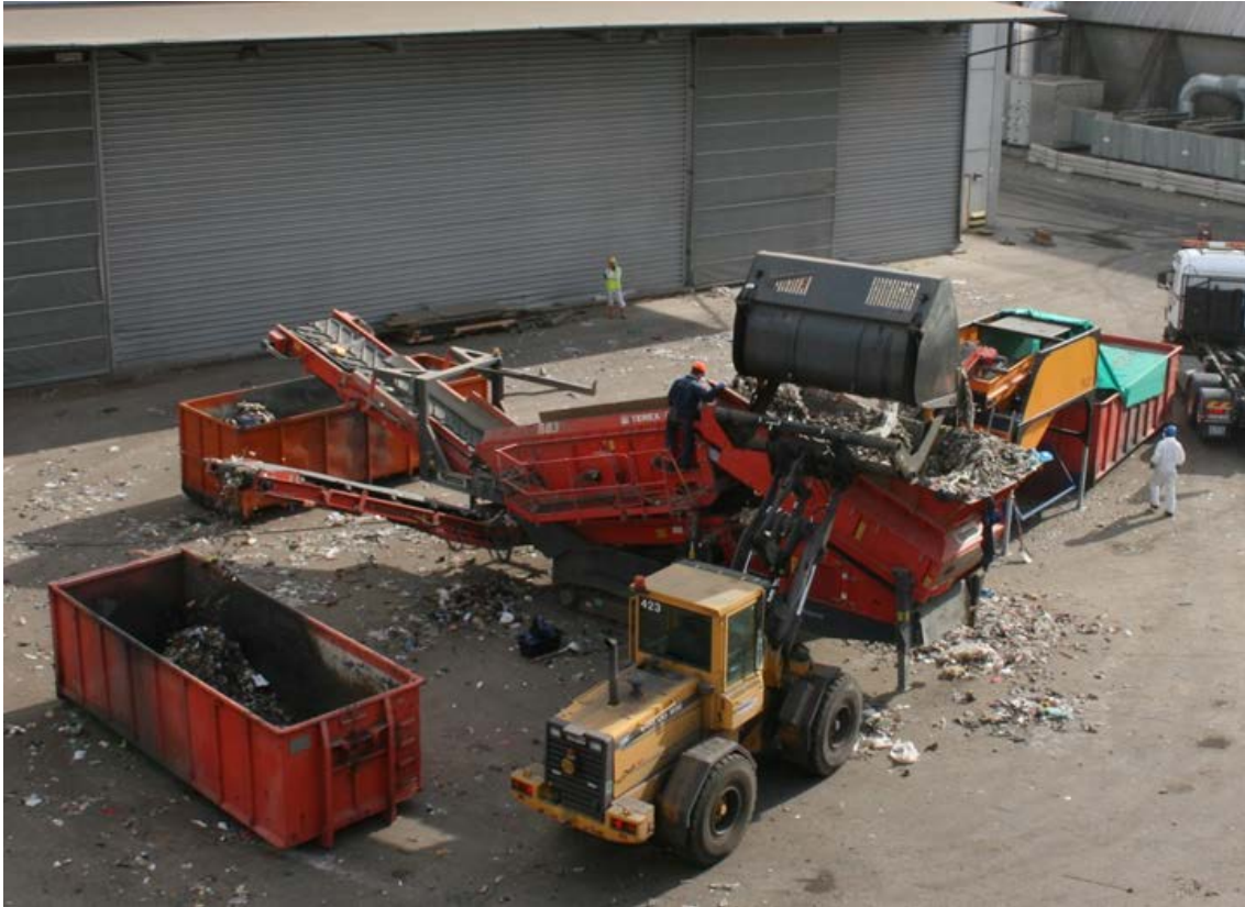
Figur 16. Grovsiktning och vindsiktning av avfall som körts genom både primär- och sekundärkrossning
