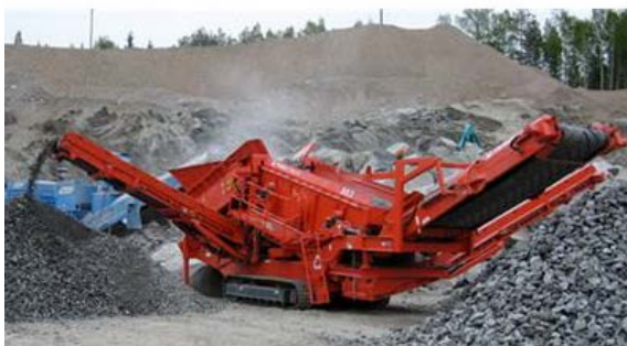
Figur 4. Grovsikt, Terex Finlay 883 (Foto. Norditek AB).
