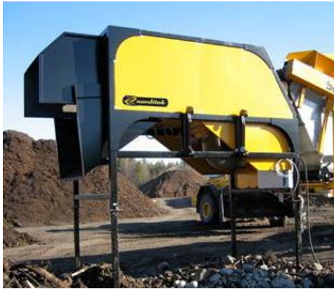
Figur 6. Vindsikt, Norditek VS1200 (Foto: Norditek AB)
