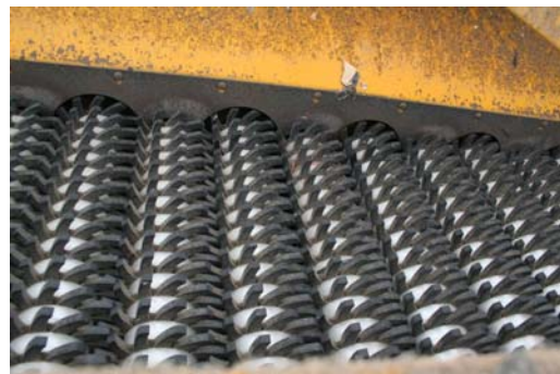
Figure 2. (a) Uppställning av stjärnsikt och det extra siktningsdäcket. (b) Stjärnsikten sedd från frontlastarens vy (Figur 1a). (c) Vy över ett av siktdäcken.
