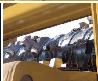
Hårdpåsvetsning som förlänger rotorrotets livslängd.
