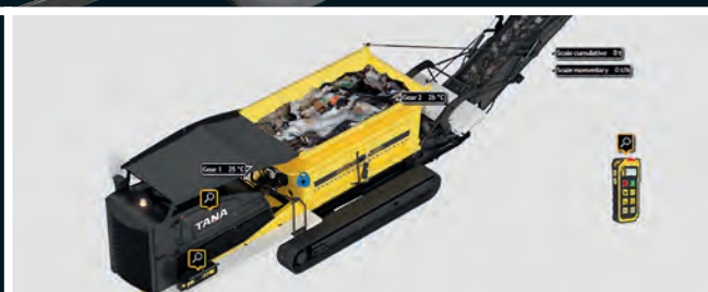
Realtidsvy av maskinen via TANA SMART SITE™ för snabb och exakt felsökning och möjligheter till förebyggande underhåll genom Tana Servicecenter
